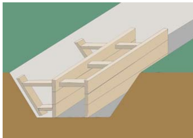
fot. 2. Skarpy wykopu muszą być pochyłe, aby nie osypywała się do niego ziemia; łąwy w deskowaniu to najpopularniejszy sposób wykonania fundamentu.
