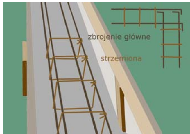
fot. 4. Przygotowane poza wykopem panele zbrojenia należy ustawić na chudym betonie; elementy konstrukcji łączy się drutem wiązałkowym.
