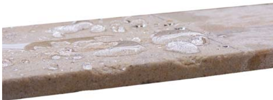
fot. 1 Środki hydrofobowe chronią mury przed nasiąkaniem wodą.
