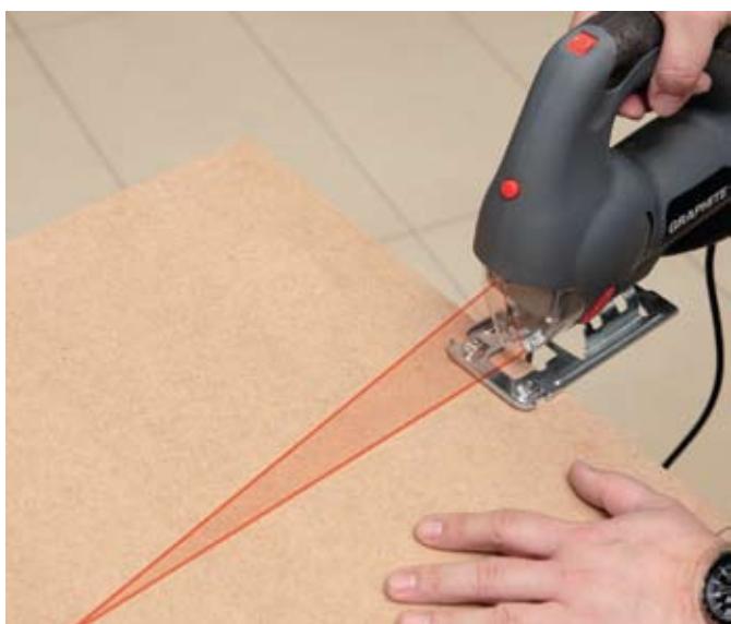
fot. 3. dobrze wyregulowany wskaźnik umożliwia cięcie po linii prostej bez konieczności rysowania całej linii
