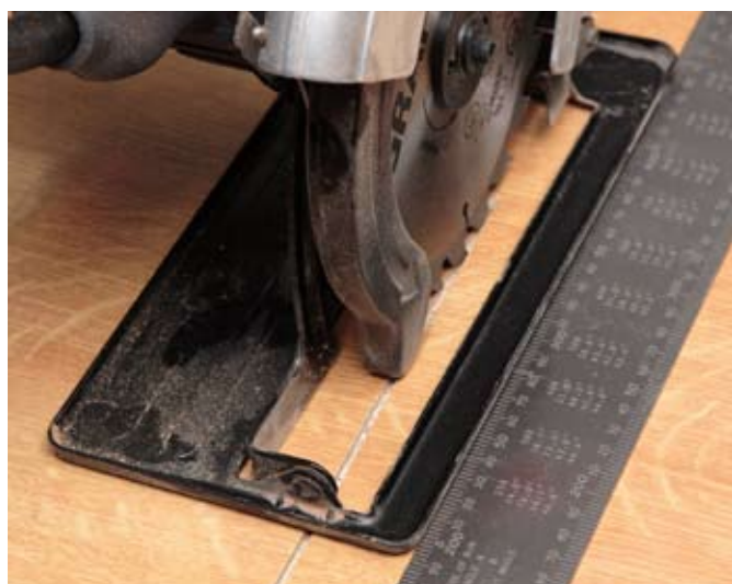
fot. 5. możliwość „nacinania” materiału na żądaną głębokość, dzięki płynnej regulacji głębokości cięcia.
