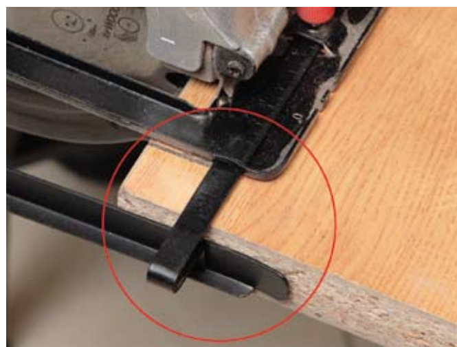
fot. 7. dodatkowa przykładnica do cięcia równoległego
