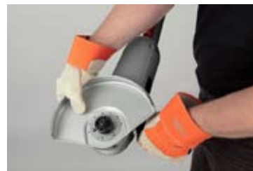
beznarzędziowa regulacja osłony tarczy
