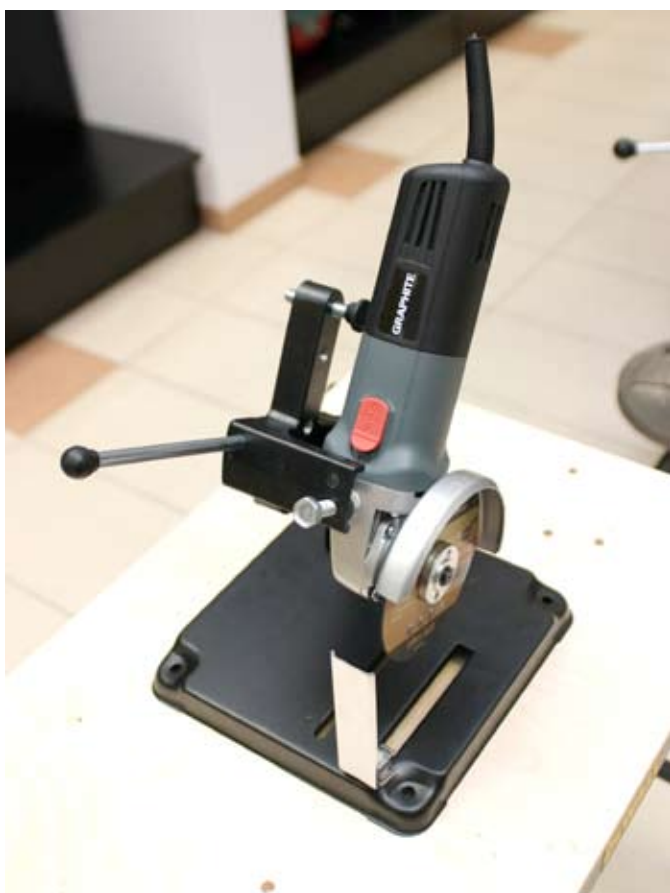
fot. 4. Dzięki zamontowaniu w odpowiednim uchwycie szlifierkę kątową można przekształcić w stacjonarną przecinarkę
