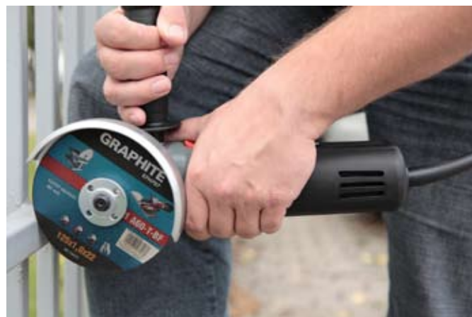
fot. 6. Prawidłowe trzymanie szlifierki (wloty powietrza odsonięte)
