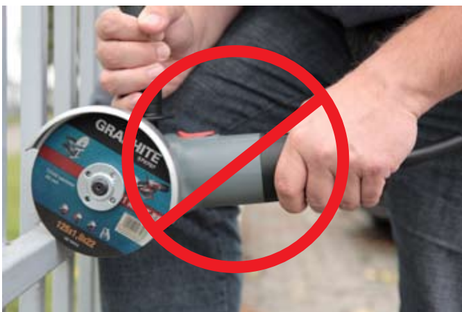
fot. 5. Nieprawidłowe trzymanie szlifierki (zablokowane wloty powietrza)
