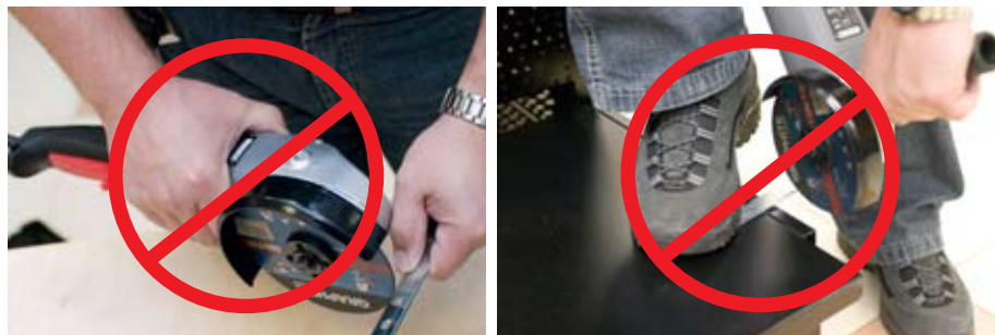
fot. 1 i 2. Przecinanych elementów nie wolno trzymać w ręku ani przytrzymywać nogą!
